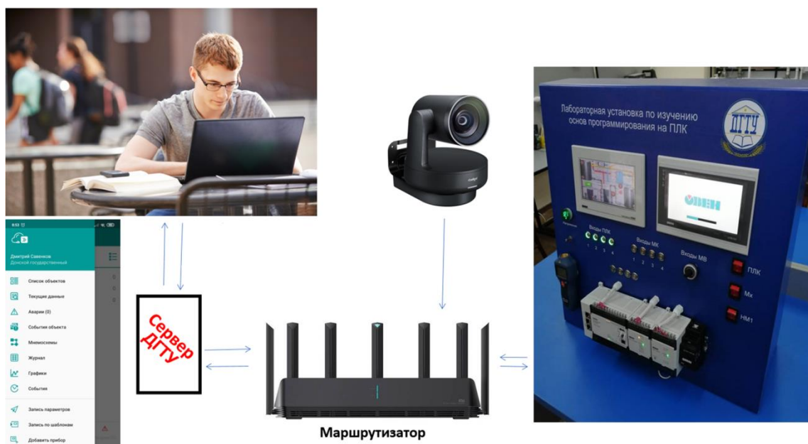
Рисунок 1 – «Функциональная» технология удаленного подключения к лабораторным установкам.
